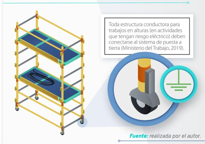
**Figura 65.** Requerimiento de construcción para escaleras con riesgo eléctrico
